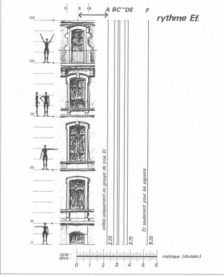
Fig. 9. — Modèle des fenétres utilisé dans la composition. Le rythme est exprimé par «Ef-x» et en mètre (division octamétrique). Il est intéressant d'observer que l'architecte ne maîtrise pas encore la division décimale, pourtant en vigueur depuis quelques années.
