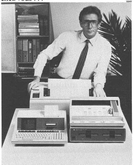
Il est transportable et autonome, ne pesant que 10 kg, son volume est celui d'une machine à écrire. Il possède un écran, un clavier, une imprimante thermique et une cartouche magnétique. Le langage BASIC étendu rend aisée son utilisation.
