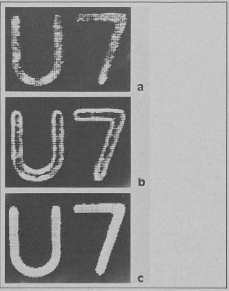
Des caractères faiblement contrastés ou même altérés peuvent être par-faitement reconstitués grâce au pro-cédé élaboré par Siemens. La figure (a) montre un dessin dans leurs que de gris, pris avec un convertisseur d'image CCD de 122 × 190 points image. Une diffé-
