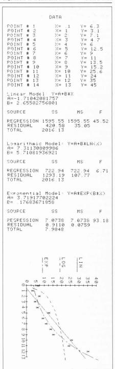
Fig. 4. — Exemple de sortie de l'imprimante incorporée. De haut en bas: Tabulation de points de mesure — Modèles mathématiques utilisés pour une description analytique de la courbe de mesure — Tracé des points de mesure et des courbes calculées. La rotation de 90° du diagramme est automatique et permet de tracer des diagrammes comportant une longueur sur l'axe des abscisses supérieure à celle de l'axe des ordonnées. Largeur de l'original: 1,6 fois celle de la figure.
