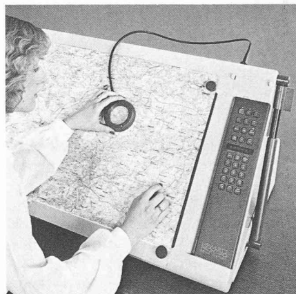
Fig. 1. — Lecteur de coordonnées permettant la conversion de données graphiques en données numériques (Hewlett-Packard HP-9874 A).
