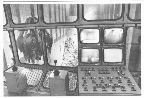
Fig. 3. — Les principales opérations de contrôle du fonctionnement de l'usine d'incinération de Monthey s'effectuent par un réseau de télévision interne.
