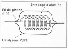
a) Schéma de principe d'un pellistor. Longueur réelle : environ 1 mm.
