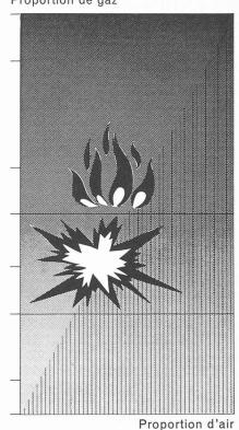
Fig. 2. — Domaines différents du mélange de gaz combustible et d'air (source : Cerberus).
