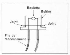
b) Structure d'un pellistor. Fig. 5. — Pellistor.
