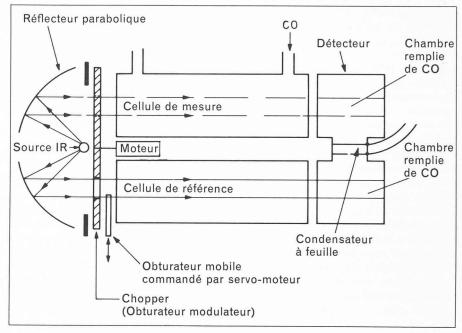
$\textit{Fig. 7.} \ \, - \textit{Principe de mesure par photomètre à rayons infrarouges (NDIR = \textit{Non-Dispersive Infra-Red Analyzer)}.$
