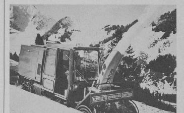
Fraiseuse à neige spéciale, type VF-PH 14, à transmission hydrostatique, largeur d'attaque 1400 ou 1600 mm, haut rendement, puissance totale
