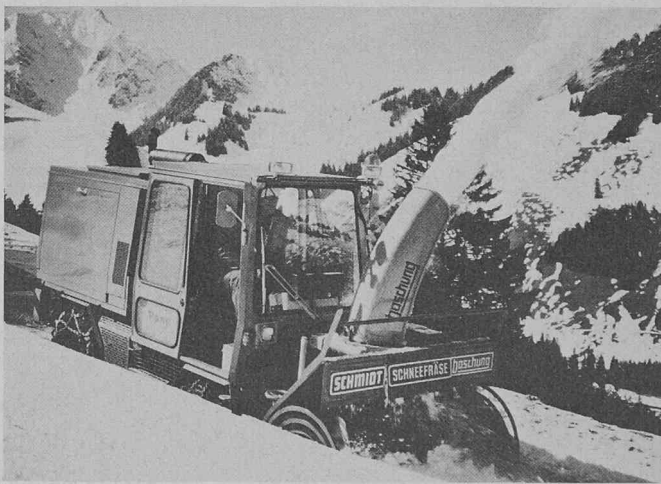
Fraiseuse à neige spéciale, type VF-PH 14, à transmission hydrostatique, largeur d'attaque 1400 ou 1600 mm, haut rendement, puissance totale 110 ch.
