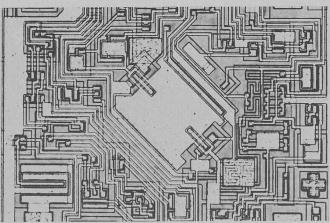
Circuit intégré, amplificateur à effet Hall: au milieu des transistors, condensateurs et résistances se trouve la sonde à effet Hall, surface magnétosensible. La photo montre la pastille (1,5 mm×1,6 mm) d'un circuit intégré numérique à effet Hall (SAS 251) utilisé par millions dans les claviers, sous forme d'interrupteur sans contact à commande magnétique.
