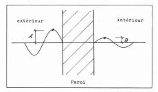
Fig. 7. — Schéma de l'amortissement d'amplitude.
