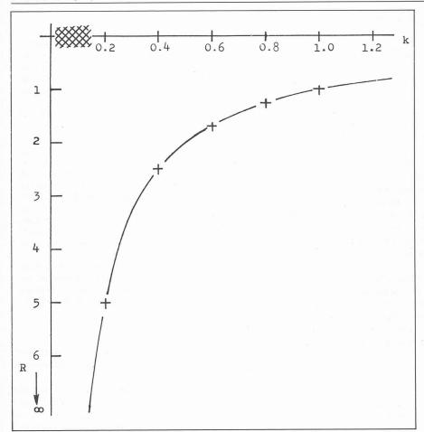
Fig. 3. — Relation entre le coefficient k et la résistance thermique. On remarque que certaines isolations ne sont simplement pas réalisables en pratique.
