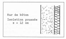
Fig. 8. — Isolation poussée d'un mur de béton.
