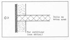
Fig. 5. — Situation avec l'isolation extérieure.
