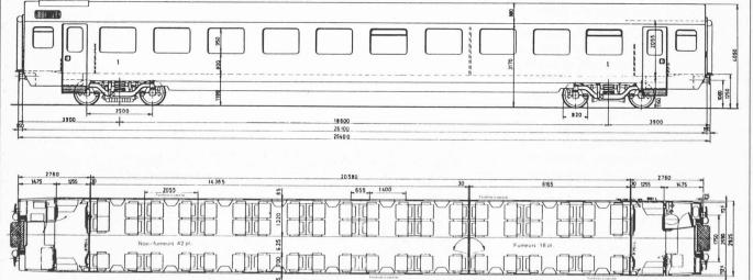
compte de la nature sinueuse du réseau suisse. Une faible résistance au pivotement améliore la capacité d'inscription en courbe et réduit l'usure des bandages. Le frein à disque, monté sur tous les essieux, est complété pour des raisons de sécurité par un frein magnétique sur rail, qui équipe un bogie par voiture. Le frein à sabots, au fonctionnement bruyant, est dès lors superflu.
