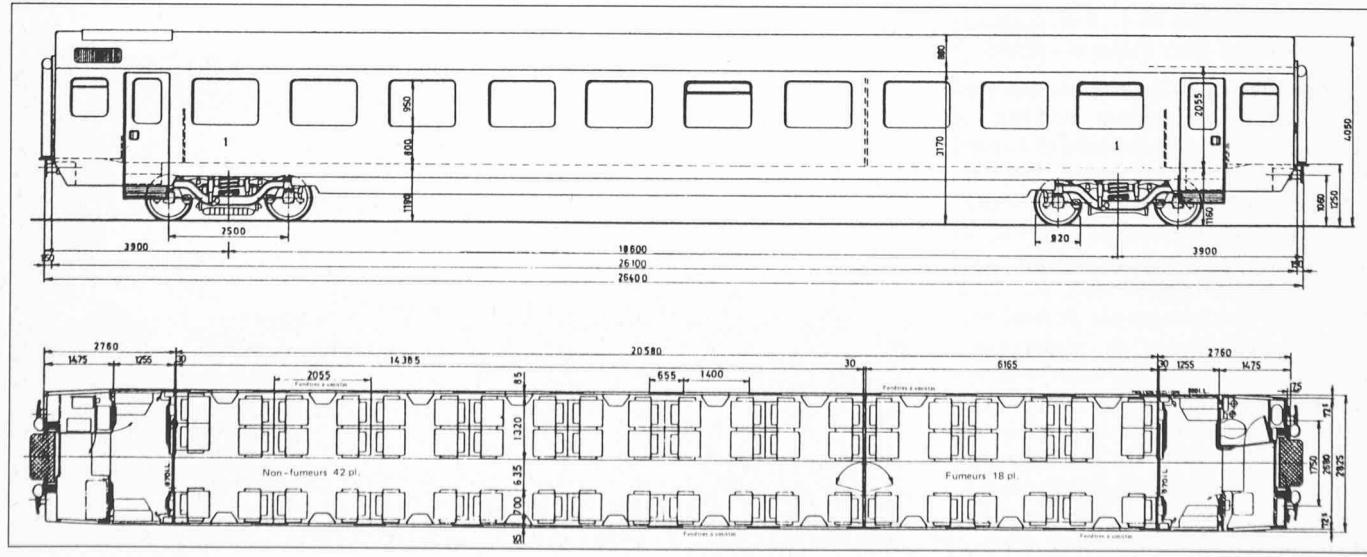
compte de la nature sinuose du réseau suisse. Une faible résistance au pivotement améliore la capacité d'inscription en courbe et réduit l'usure des bandages. Le frein à disque, monté sur tous les essieux, est complété pour des raisons de sécurité par un frein magnétique sur rail, qui équipe un bogie par voiture. Le frein à sabots, au fonctionnement bruyant, est dès lors superflu.
