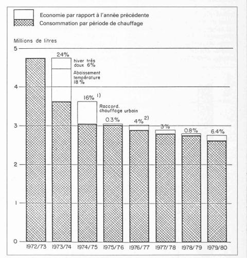
Fig. 1. — Consommation de mazout dans 31 bâtiments de l'administration fédérale à Berne. Economie par suite de l'abaissement de la température des bureaux, de la réduction de la période de chauffage, de l'amélioration du réglage des installations de chauffage et du raccordement de bâtiments à la centrale urbaine de chauffage.
