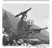
Par-delà le Gothard également, on travaille activement à l'ouvrage routier le plus imposant de Suisse à la N2 qui doit relier Bâle à Chiasso. Sur la couverture, on voit le jumbo de forage hydraulique Atlas Copco Promec TH470 sur le tronçon de « Biaschina » entre Airolo et Bellinzone.
