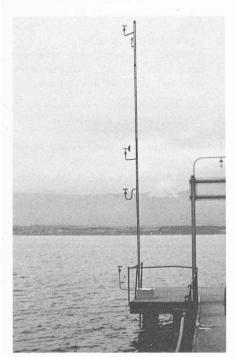
Fig. 8. — Station anémométrique de la pointe de Messery.
