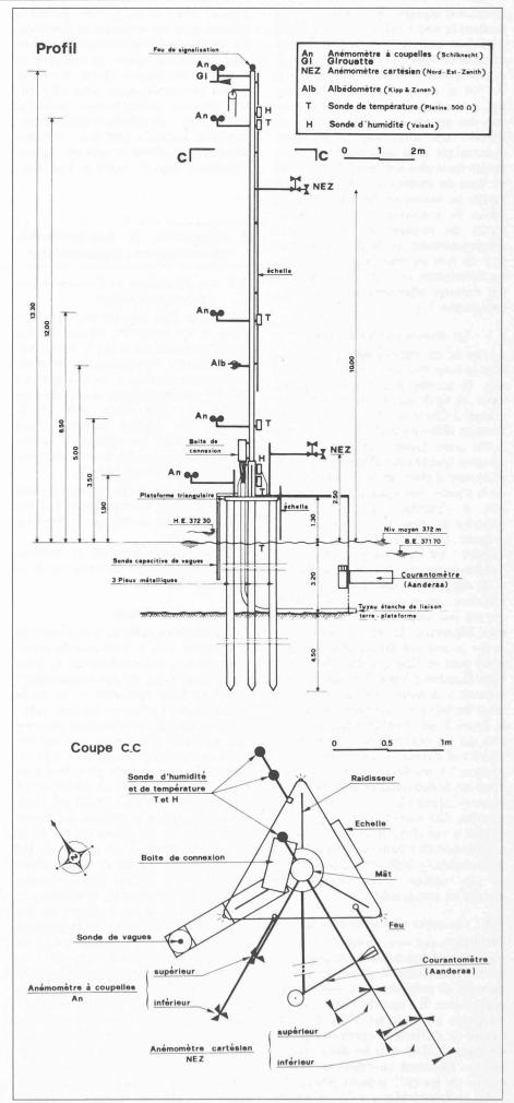
Fig. 4. — Plate-forme fixe de Chanivaz; profil et plan schématiques.
