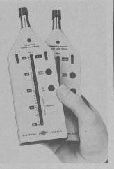
que le niveau sonore énergétique équivalent  $L_{\rm eq}$  sur 60 sec. La mesure de  $L_{\rm eq}$  sur 60 sec élimine les imprécisions de lecture pour les bruits de niveau variable. Le SEL (Single Exposure Level) qui correspond au  $L_{\rm eq}$  rapporté à 1 sec peut facilement être déduit du niveau  $L_{\rm eq}$  mesuré. Le type 2225 offre la mémorisa-
