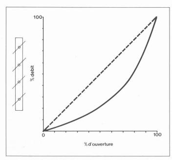
Fig. 1. — Courbe caractéristique théorique d'un registre à lames parallèles (la ligne pointillée représente la caractéristique linéaire hypothétique).
