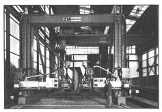
Portique de soudure automatique pour fabrication de poutres jusqu'à 4,50 m de hauteur.
