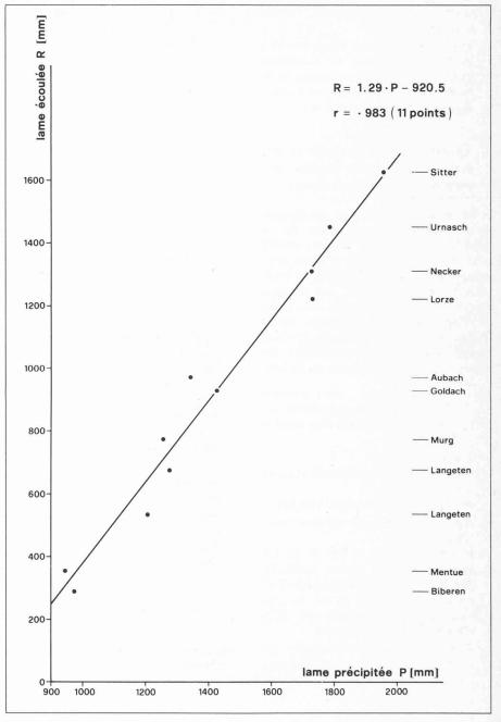
Fig. 3. — Relation entre lame précipitée P et écoulée R.
