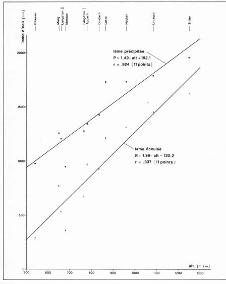
Fig. 1. — Variation des lames précipitées P et écoulées R avec l'altitude.
