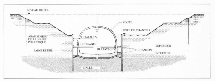
Fig. 5. - Profil en travers. Phase de travail.
