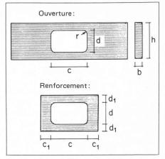
Fig. 13. — Ouverture et renforcement.  $\begin{array}{ccc} d_1 \geqslant 0,40 & d & c_1 \geqslant 0,25 & c \\ \geqslant 0,10 & h & \geqslant d_1 \end{array}$
