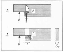
Fig. 8. — Modèle pour le dimensionnement du renforcement.
