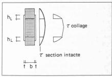
Fig. 12. — Répartition des contraintes tangentielles dans la section.
