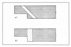
Fig. 4. — a) Renforcement par des tôles clouées en diagonale.
