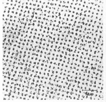
Fig. 2. — Prise de vue au microscope électronique, du filtre de flux en Pb-Tl sous I,2 K (B. Obst, Centre de recherches nucléaires à Karlsruhe).
