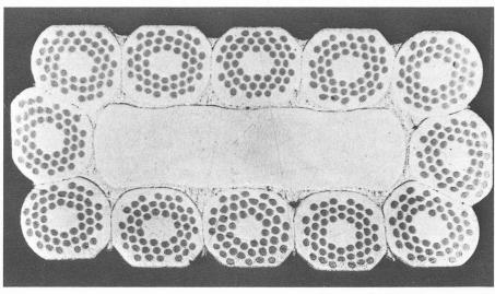
Fig. 3. — Exemple de supraconducteur en filaments câblés et soudés pour des courants élevés  $I_c=2070~A~pour~5~T~et~4,2~K.~Dimensions du~conducteur: 3,8 × 1,9 mm². (Photos Brown Boveri)$
