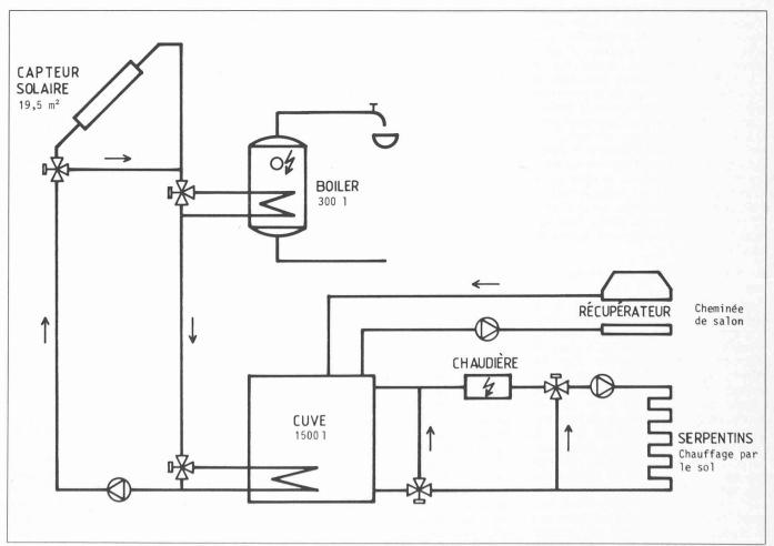
Fig. 7. — Schéma de principe.
