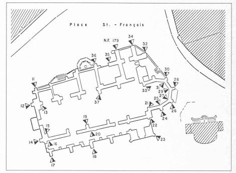
Fig. 7. — Position des points nivelés
