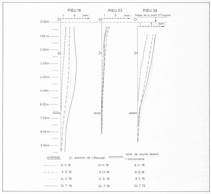
Fig. 12. — Profils des tubes inclinométriques à diverses époques.
