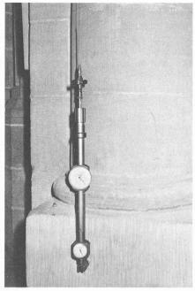
Fig. 9. — Vue du distomètre. De bas en haut: Fixation avec rotule dans le scellement, comparateur pour mesure du déplacement, comparateur du dynanomètre pour mesure de la tension dans le fil, fil d'invar
