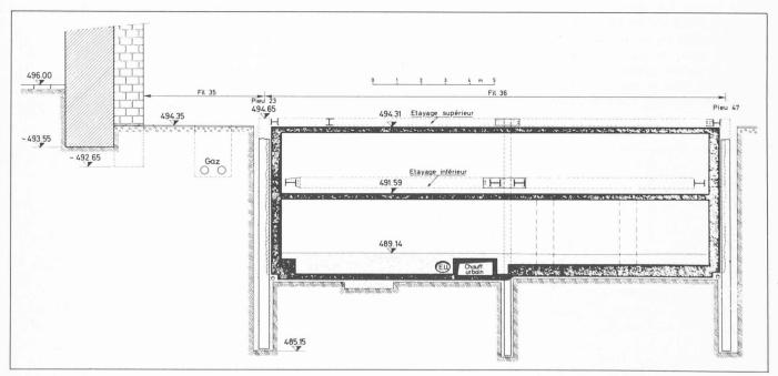
Fig. 6. — Profil de la fouille et du passage «Grotte». Dispositif de mesure:
