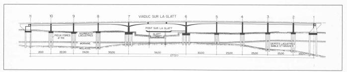
Fig. 8. — Viaduc sur la Glatt. Développement.
