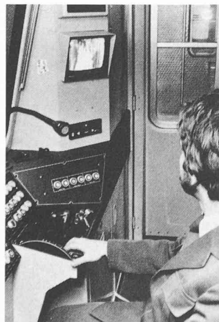
La photo montre la cabine de conduite d'une rame du métro d'Amsterdam. Sur l'écran de son moniteur, le conducteur peut observer les mouvements sur le quai, les montées et descentes des voyageurs grâce aux images transmises par une installation de télévision sans fil de Siemens.
