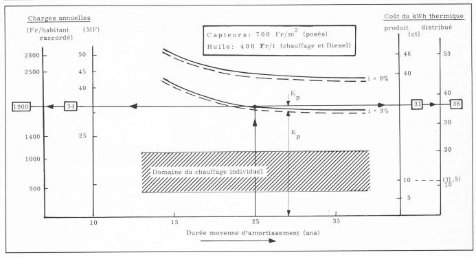
Fig. 9. - Charges annuelles et coût du kWh.
