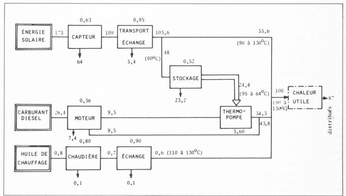
Fig. 8. — Chaîne énergétique du système (moyenne annuelle).
