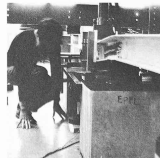
Détermination de la résistance d'une poutre métallique par un essai de charge jusqu'à la rupture, soit environ 30 tonnes (photo Foetisch).
