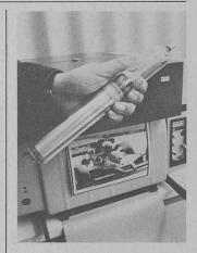
Ce tube est utilisé dans le nouveau récepteur de téléphotos TM 4006 de la société Dr.-Ing. Rudolf Hell GmbH. Le rayon laser reproduit la photo sur du papier « dry-silver » en rouleau. Un système automa-tique de développement thermique permet d'obtenir la photo définitive.
