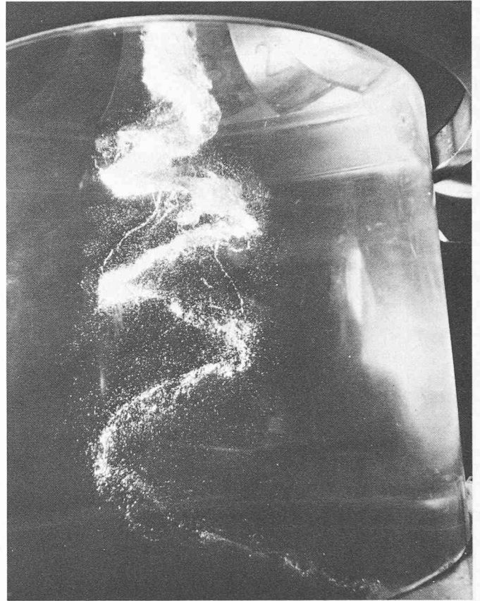
Fig. 6. — Torche de débit partiel. Essai de cavitation sur modèle réduit de LG 3.
