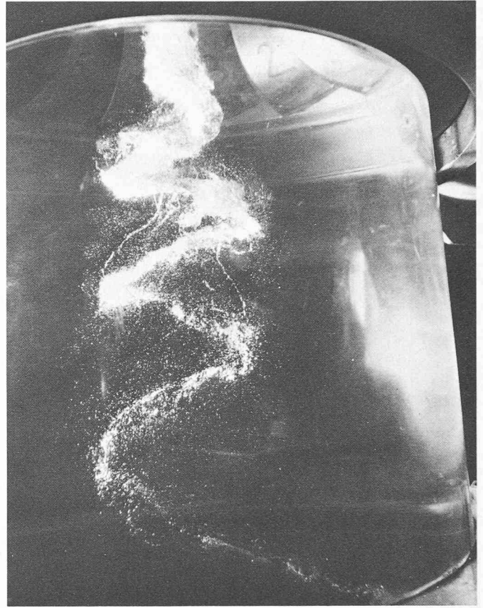
Fig. 6. — Torche de débit partiel. Essai de cavitation sur modèle réduit de LG 3.
