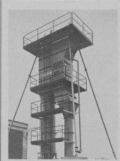
Installation pilote pour essais de décantation.
