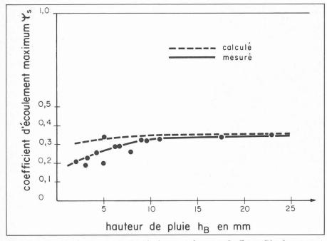
Fig. 15. — Quartier de Küngenmatt, Zurich, à maisons locatives. Coefficient d'écoulement maximum mesuré et calculé.
