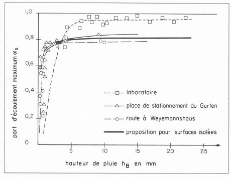
Fig. 12. — Part d'écoulement maximum pour surfaces isolées — asphalte.
