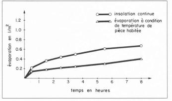
Fig. 5. — Béton de haute qualité. Evaporation d'eau — insolation continue, aux conditions de température de pièces habitées.
