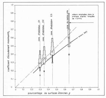
Fig. 16. — Coefficients d'écoulement maximum  $\psi_s$  par rapport au pourcentage de surfaces étanches  $\gamma$ . Comparaison des valeurs utilisées dans la pratique avec celles que l'étude a permis de mesurer.
