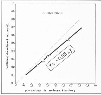
Fig. 17. — Diagramme pour déterminer les coefficients d'écoulement maximum.
