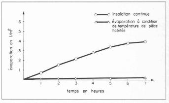
Fig. 6. — Vieille tuile. Evaporation d'eau ditions de température de pièces habitées. - insolation continue, aux con-
