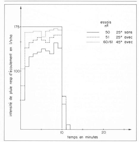
Fig. 9. — Essais de laboratoire : courbe d'écoulement des eaux pluviales — asphalte.
