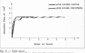
Fig. 4. — Tuile neuve. Absorption d'eau lors d'une pluie simulée continue et intermittente.
