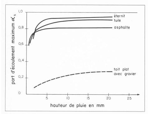
Fig. 13. — Part d'écoulement maximum pour des surfaces isolées.
