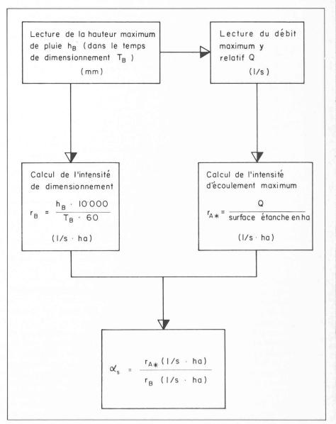
Fig. 11. — Procédure pour déterminer les parts d'écoulement maximum as.
