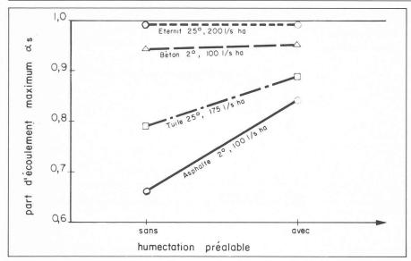
Fig. 8. — Influence de l'humectation préalable sur la part d'écoulement maximum as.
