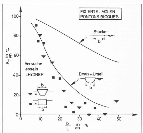
Fig. 4. — K<sub>T</sub> en fonction de la largeur « b » pour quatre formes de la barrière fixe.
