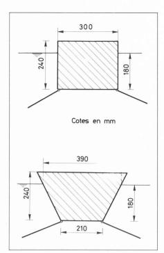
Fig. 9. — Schéma des deux profils de caissons essayés.
