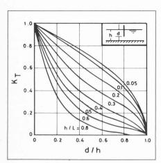
Fig. 2. — Coefficients de transmission  $K_T$  d'un écran vertical.
