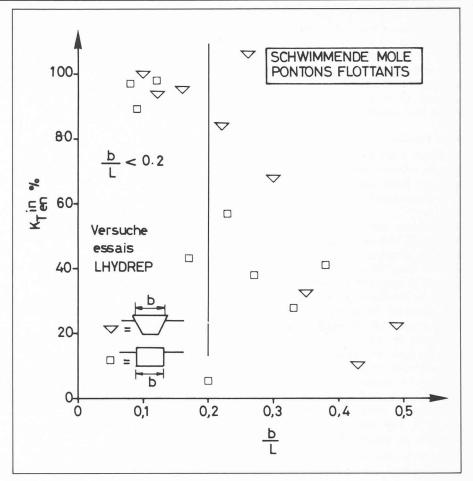
Fig. 11. — K<sub>T</sub> en fonction de la largeur relative d'une digue flottante.
