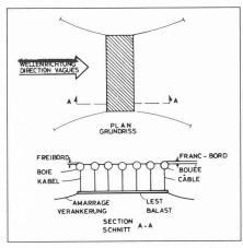
Fig. 5. — Digue à bouées (TFB-Tethered Float Breakwater).
