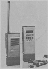
Un appareil spécial de programmation de code grand comme un émetteur-récepteur manuel assure l'introduction du code orthogonal 2,35 × 10<sup>21</sup> (empêchant la diaphonie). La mémorisation de code par microprocesseur incorporé se fait sous forme traitée, c'est-à-dire que le code ne peut être déchiffré dans son format d'origine à 24 chiffres. On peut donc se séparer de l'appareil de programmation sans mettre en cause la sécurité du code. Photo: Motorola.
