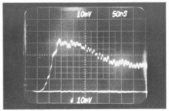
Fig. 6. — Impulsion de champ magnétique mesurée sous l'antenne.
