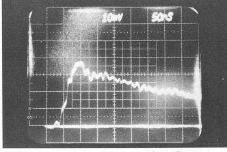
Fig. 8. — Impulsion de champ électrique mesurée sous l'antenne.
