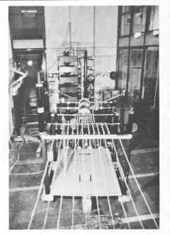
Fig. 2. — Vue de l'ensemble du laboratoire. Au fond : générateur de Marx A l'avant : unité à front raide couplée à l'antenne
