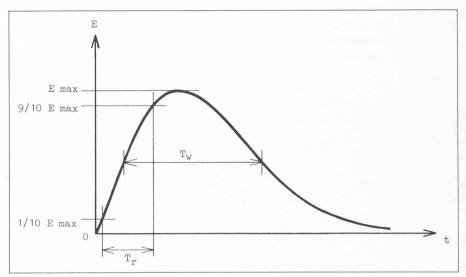
Fig. 1. — Forme normalisée d'une impulsion perturbatrice.
