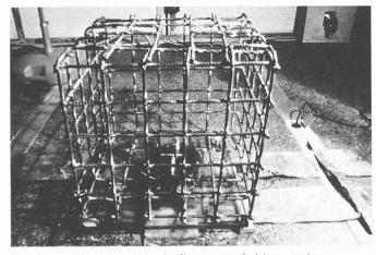
Fig. 10. — Maquette constituée d'armatures de béton armé.
