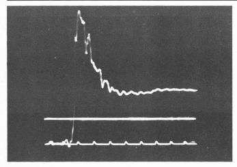
Fig. 3. — Impulsion de tension au bout de l'antenne.
