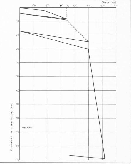
Fig. 9. — Déplacement vertical de la tête du pieu en fonction de la charge appliquée — Pieu d'essai est (DF22).
