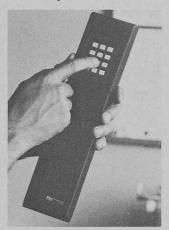
L'appareil de cryptage de conversations Brown Boveri Vericrypt 1100 garantit la préservation du secret des échanges d'informations. Il est spécialement conçu pour être utilisé dans les réseaux radio mettant en œuvre des radiotéléphones portatifs. La méthode de codage temporelle utilisée convient pour tous les systèmes radio connus (photo Brown Boveri).
