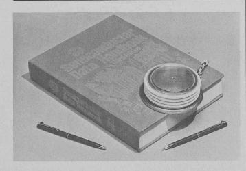
Thyristor d'une puissance de 3250 kW!
