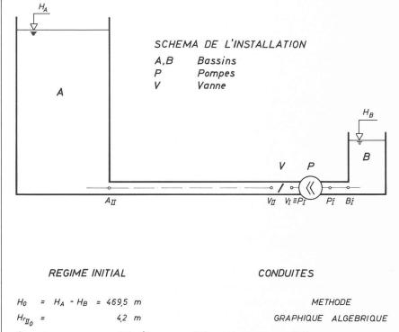
832 m3/s AVAL 95,5 Lī m 0 1000 t/min  $D_{\bar{I}}$  m 1,6 1047 rad/s Ai m/s 500 AMONT LI m 977,4 POMPE  $D_{II}$  m 2,1 2,1  $J = 19250 \text{ kgm}^2$ 1279 avec  $\frac{L_{II}}{A_{II}} = n \cdot \frac{L_{I}}{A_{I}}$  n entier  $\dot{V} = \bar{C} \cdot S$
