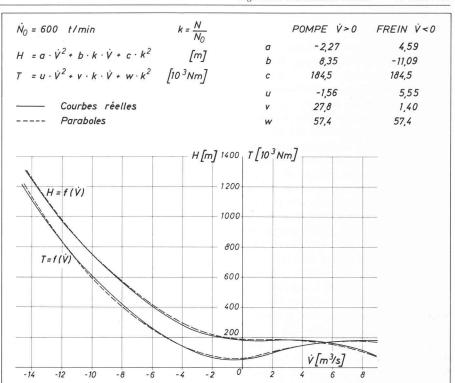
Fig. 8. — Caractéristiques de fonctionnement de la machine hydraulique en régimes «pompe» et «frein». Le calcul utilise des paraboles aussi proches que possible des courbes réelles. Chacune de ces paraboles est définie par trois coefficients:
