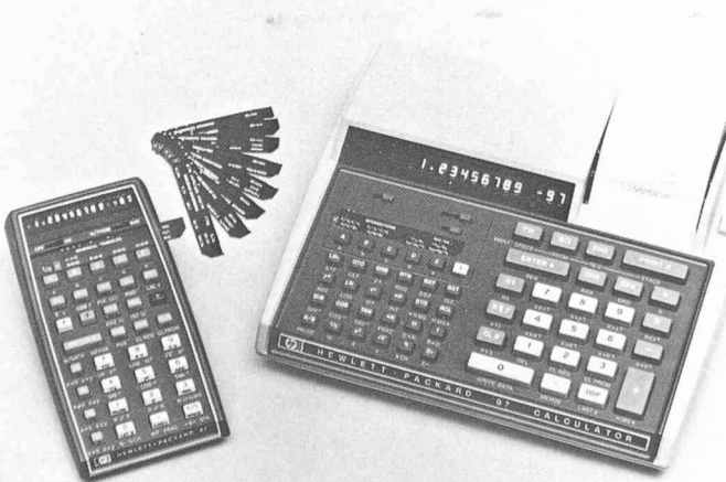
Fig. 1. — Calculatrices Hewlett Packard HP 67, de poche, et HP 97, portable avec imprimante. Ces deux modèles, qui présentent une capacité et une logique identiques, utilisent les mêmes cartes magnétiques d'enregistrement (photo Hewlett Packard).
