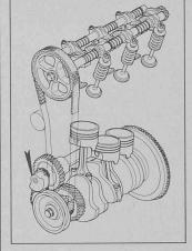
Fig. 2. — Disposition du vilebrequin, du vilebrequin d'équilibrage dyna-mique (flèche) et de la commande des soupapes par arbre à cames en tête.
