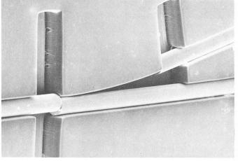
Cette photographie prise au microscope électronique à balayage, montre une dérivation assurant le découplage de lumière dans une fibre optique. Pour réaliser de telles structures de dérivation, Siemens a employé une nouvelle technologie planar sur film épais.
