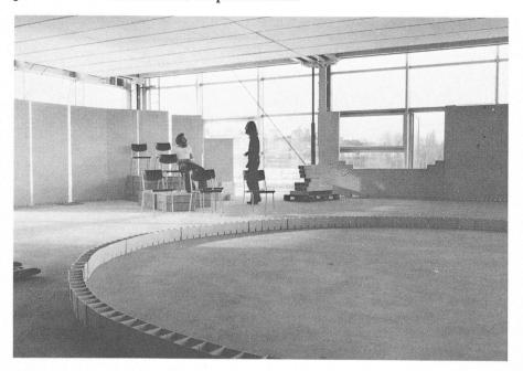
Le Laboratoire d'expérimentation architecturale mis en service en 1977 est une halle où l'on peut reproduire des plans d'architecture en grandeur nature. Un système de plots à emboîtement, des plates-formes mobiles et divers autres accessoires permettent la simulation rapide et aisée des espaces architecturaux: plans d'appartements, de maisons, de classes scolaires, de bibliothèques, chambres de malades, etc.
