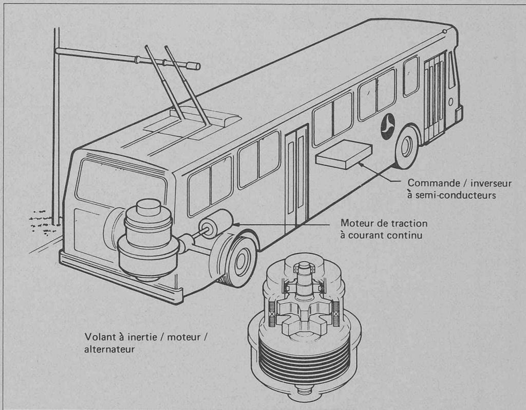
Selon le Centre de recherches de General Electric, l'autobus à volant d'inertie est tout aussi propre et silencieux que le trolleybus conventionnel. Il permet cependant une plus grande souplesse dans le choix du parcours, car il ne nécessite pas de ligne électrique coûteuse et génératrice de pannes. *A lire le communiqué ci-dessus, nombre de nos lecteurs auront éprouvé un certain étonnement ou*
