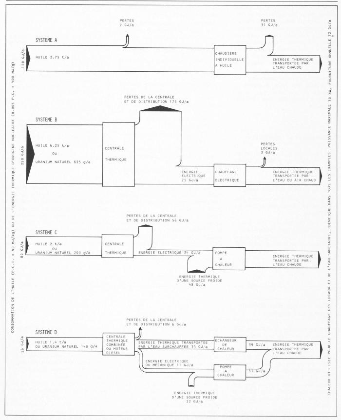
Fig. 4. — Flux d'énergie pour quatre systèmes de chauffage.
