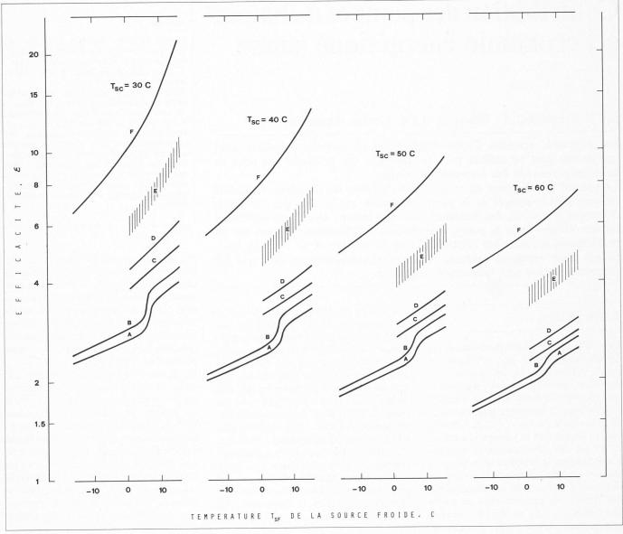
Performances des pompes à chaleur typiques, entraînées par les moteurs électriques. Fig. 1. — Pe Nomenclature
