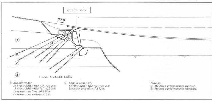
Fig. 3. — Coupe longitudinale de la passerelle tendue précontrainte de Sappro sur le Rhône au Lignon.
