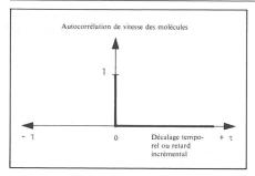
Fig. 2. — Autocorrélation de vitesse d'un phénomène « purement » aléatoire.
