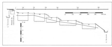
Fig. 3. — Profil en long du terrain et profil hydraulique correspondant à la fig. 2.
