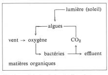
Fig. 1. — Principe du bassin d'oxydation.
