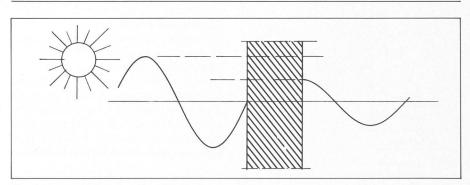
Fig. 3. — Inertie thermique. k = k, quelle que soit l'inertie interne.
