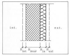
Fig. 1.  $R_{\rm tot} = \sum R_{\rm superficielles} + \sum R_{\rm \'el\'ements} \\ (°C \cdot m^2/W)$
