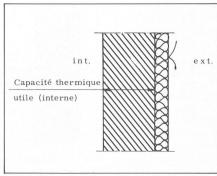
Fig. 4. — Répartition de la capacité de stockage thermique.
