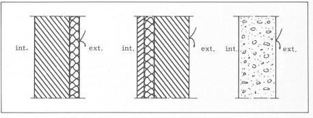
Fig. 2. — Position de l'isolant. A résistance thermique égale : k=k, quelle que soit la position de l'isolant.
