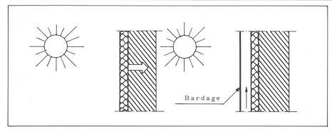
Fig. 5. — Capacité de transmettre des apports extérieurs. k = k: les flux provenant de l'extérieur sont différents.
