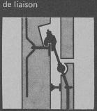
Attaches pour panneaux de parement
