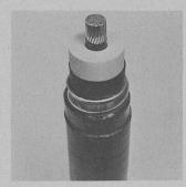
Câbles haute tension 150 kV à isolation EPR et gaine ondulée en aluminium, type GALW-T, 1×300 mm².
