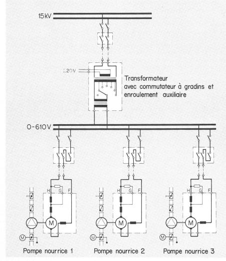
Fig. 12. — Schéma électrique de l'entraînement des pompes.
