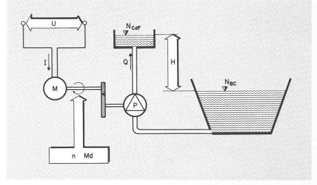
Fig. 14. — Schéma de principe du système pompes nourrices.
