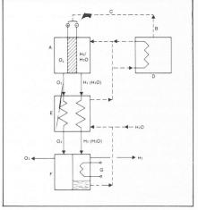
. 2. — Schéma d'une installation d'électro-à haute température. Légende : Electrolyseur à haute température Chaleur du processus Energie électrique Réacteur à haute température AB Echangeur calorifique
