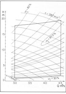
Fig. 10. — Caractéristiques des pompes nourrices.
