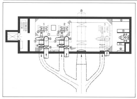
Fig. 9. — Vue en plan de l'étage des pompes nourrices.
