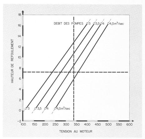
Fig. 15. — Instrument d'indication des débits pompés, en fonction de la hauteur de refoulement et de la tension.
