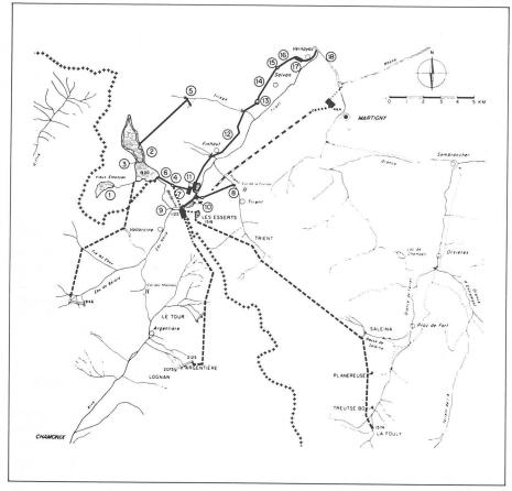
Fig. 1. — Situation d'ensemble des installations d'Electricité d'Emosson SA (ESA) et des Chemins de fer fédéraux (CFF). Traits pleins = CFF En pointillés = ESA
