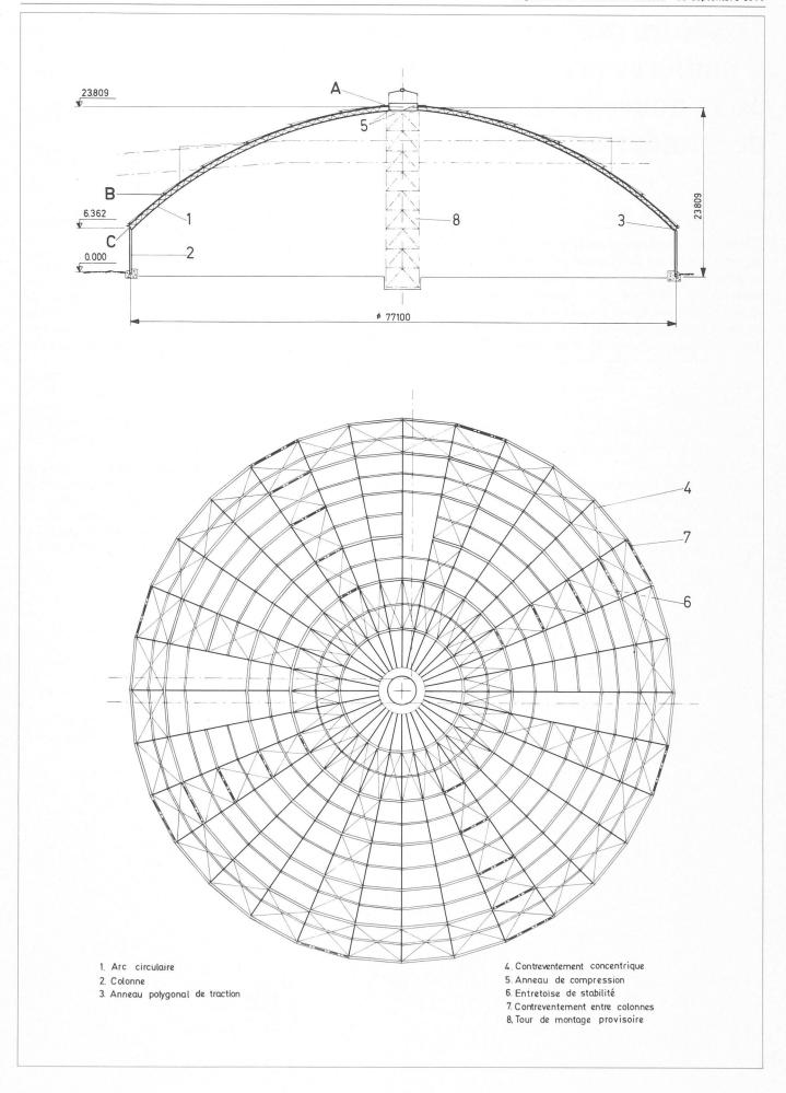
Fig. 2. — Ensemble de la coupole (∅ 77,1 m).
